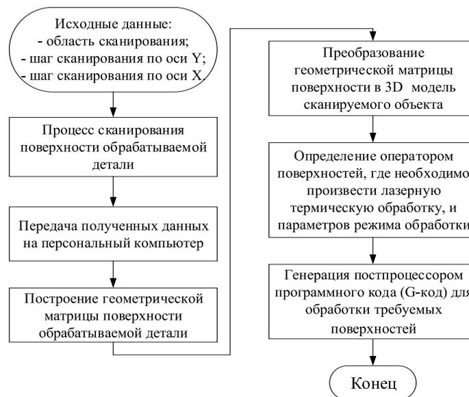
Рис. 2. Алгоритм работы лазерного технологического комплекса, оснащенного бинокулярным триангуляционным лазерным датчиком ЛД2 в режиме обучения по осям X и Y
