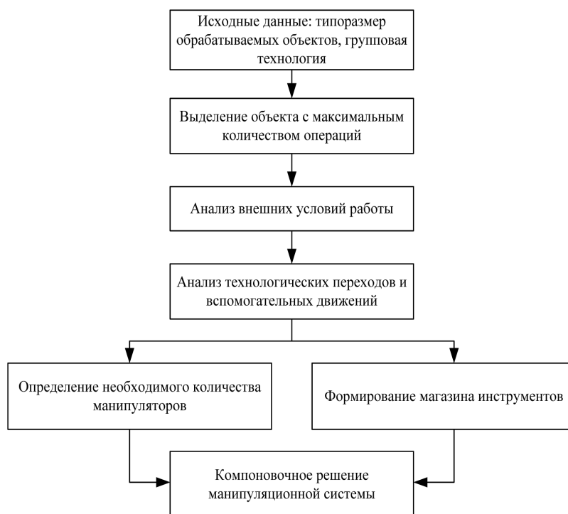
Рис. 2. Последовательность комплексования манипуляционной системы
