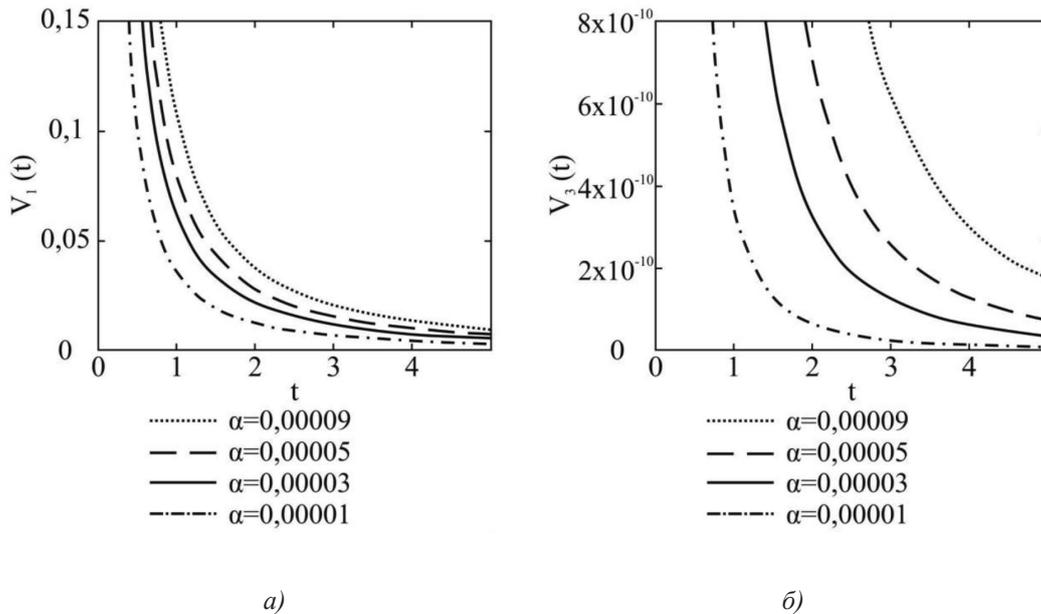
Рис. 1. Зависимости главных членов асимптотик (а) компоненты  $V_1$ , (б) компоненты  $V_3$  от времени при различных значениях частоты вращения жидкости  $\alpha$  при фиксированных значениях параметра стратификации  $\beta$  и переменной  $x_3$
