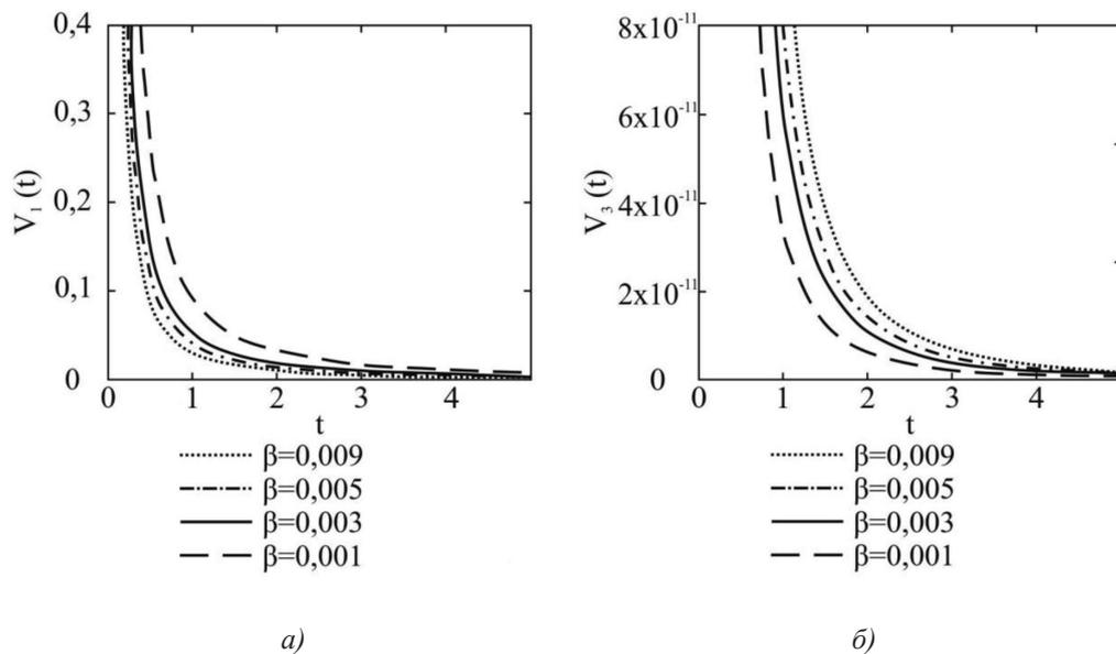
Рис. 2. Зависимости главных членов асимптотик (а) компоненты  $V_1$ , (б) компоненты  $V_3$  от времени при различных значениях параметра стратификации  $\beta$  при фиксированных значениях частоты вращения жидкости  $\alpha$  и переменной  $x_3$
