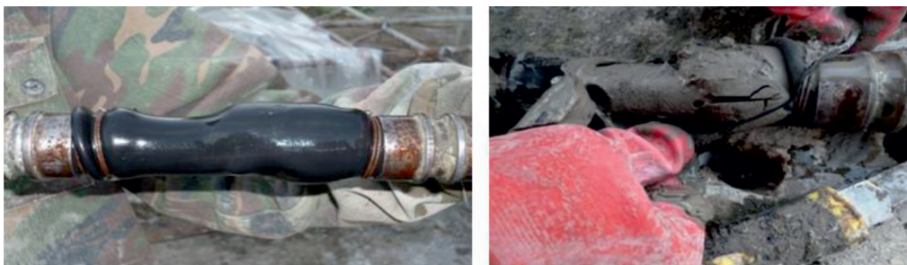
Рис. 1. Блокировка пакера в результате осаждения цементных частиц
