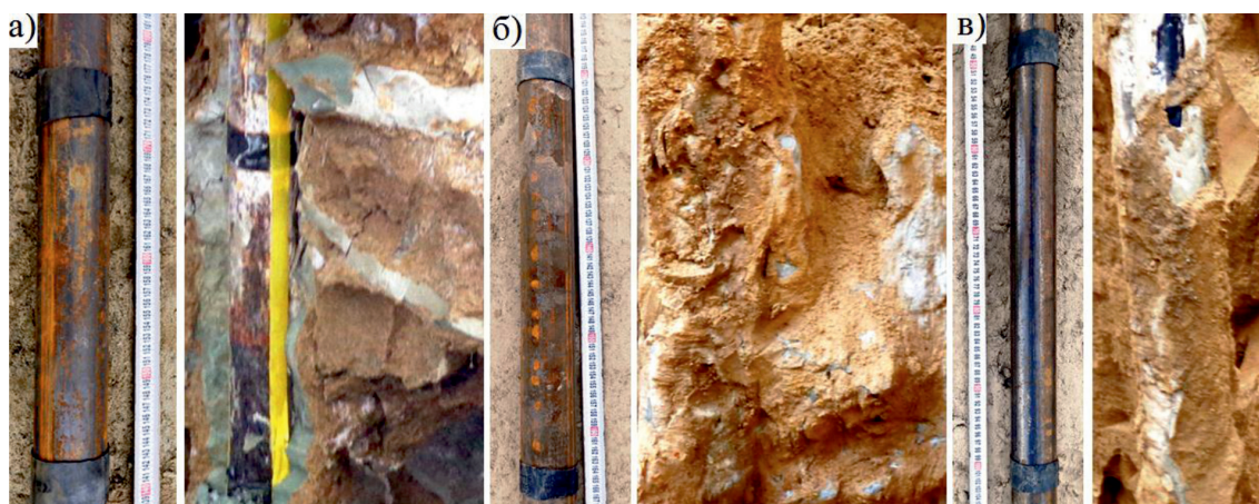
Рис. 3. Характер распространения гидроразрывов с повторной инъекцией раствора: а – при шаге отверстий 30 см, б – при шаге 40 см, в – при шаге 50 см
