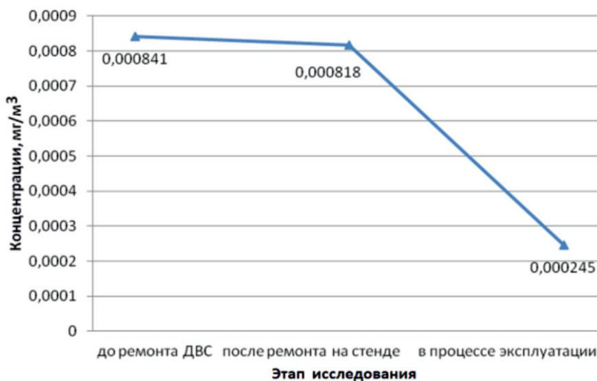
Рис. 10. Изменение концентрации Si в ОГ на различных этапах исследования
