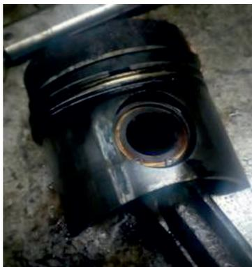
Рис. 4. Задиры на поршнях ДВС
