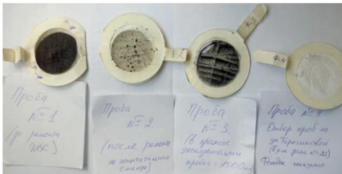
Рис. 2. Фильтры с отобранными пробами ТЧ
