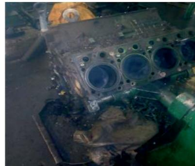
Рис. 3. Стенд для сборки-разборки ДВС
