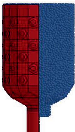
Рис. 4. Исследуемая емкость активной зоны расчетной модели с турбулизаторами
