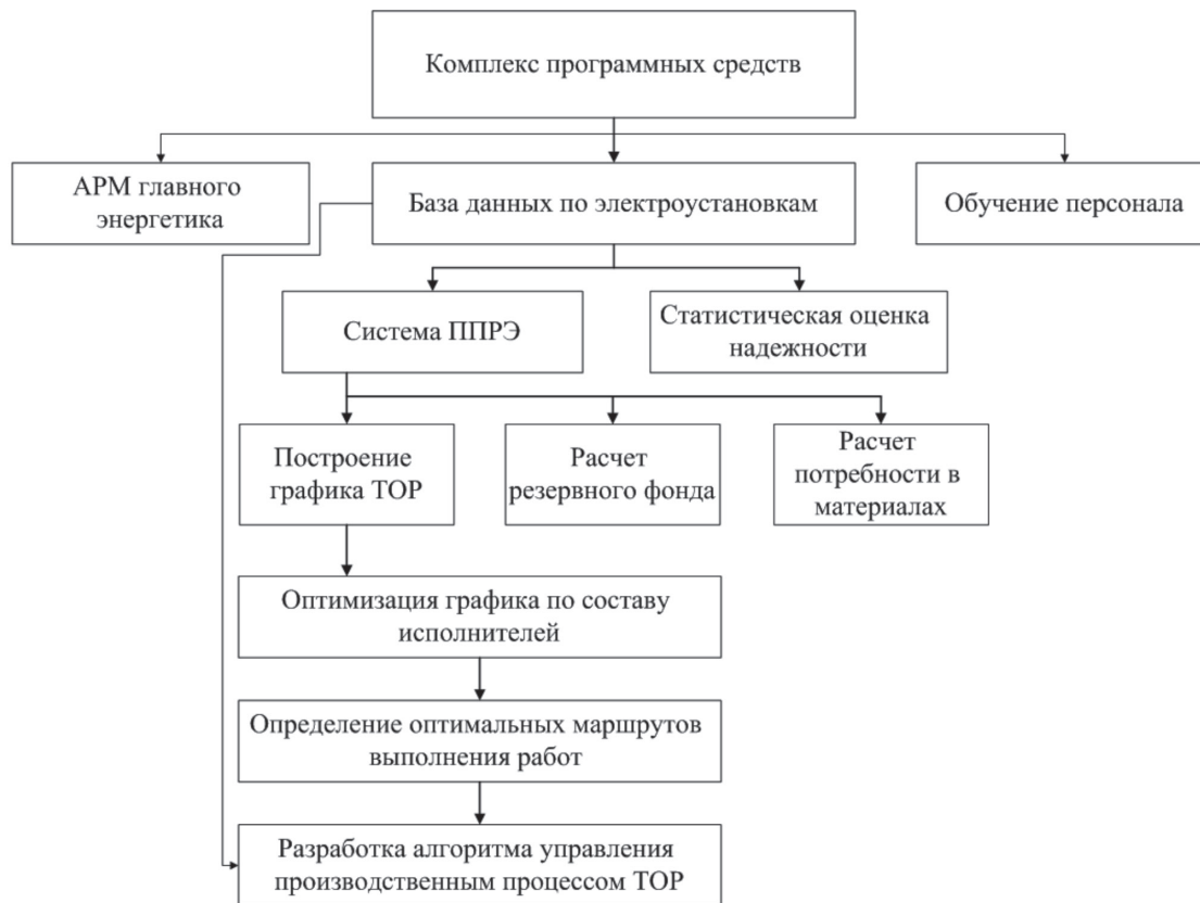
Рис. 1. Структурная схема программного комплекса для автоматизации деятельности должностных лиц электросетевого предприятия: ППРЭ – планово-предупредительный ремонт электрооборудования; ТОР – техническое обслуживание и ремонт
