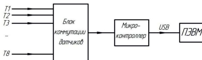
Рис. 2. Принципиальная схема автоматической обработки и передачи экспериментальных данных
