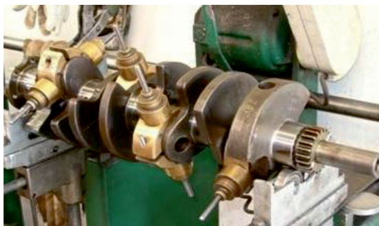
Рис. 2. Внешний вид противовесов (бобвейтов), установленных на шатунные шейки V-образных двигателей
