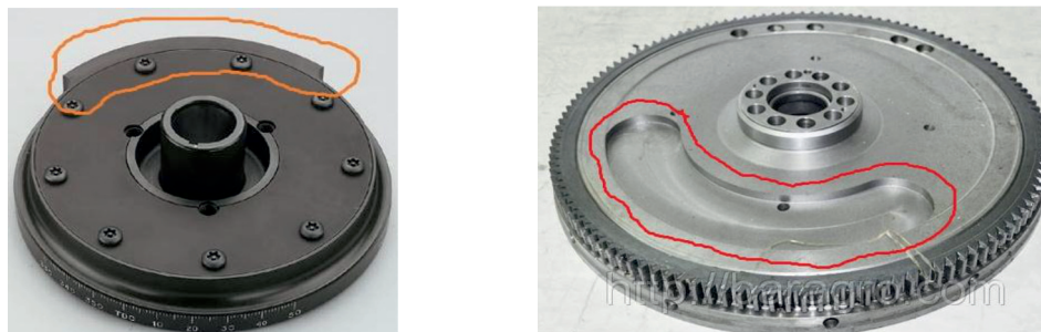
Рис. 5. Внешний вид маховика и переднего шкива при внешней балансировке
