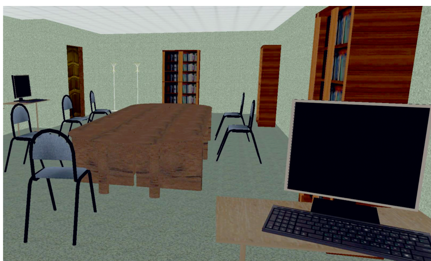
Рис. 4. Векторное изображение цифрового поэтажного плана и 3D модель, сгенерированная на его основе
