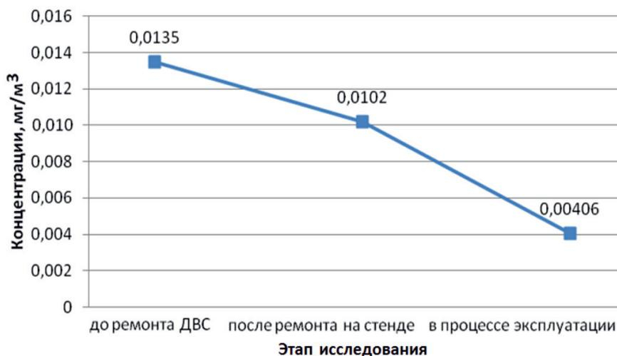
Рис. 9. Изменение концентрации Fe в ОГ на различных этапах исследования
