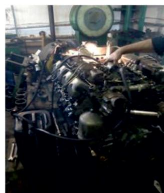
Рис. 6. ДВС КамАЗ 740.10 на стенде КИ-5274
