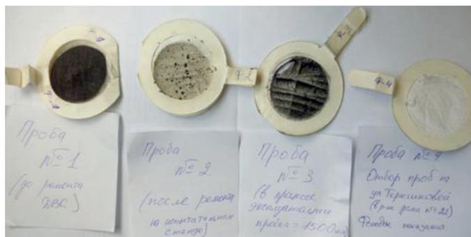
Рис. 2. Фильтры с отобранными пробами ТЧ
