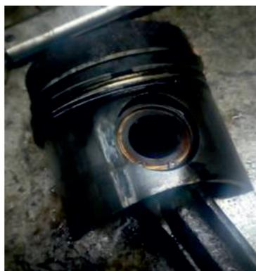
Рис. 4. Задиры на поршнях ДВС
