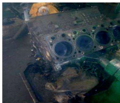
Рис. 3. Стенд для сборки-разборки ДВС
