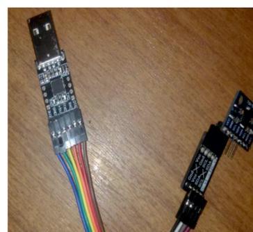
Рис. 2. GY-521 с шиной I<sup>2</sup>C и Arduino Mini
