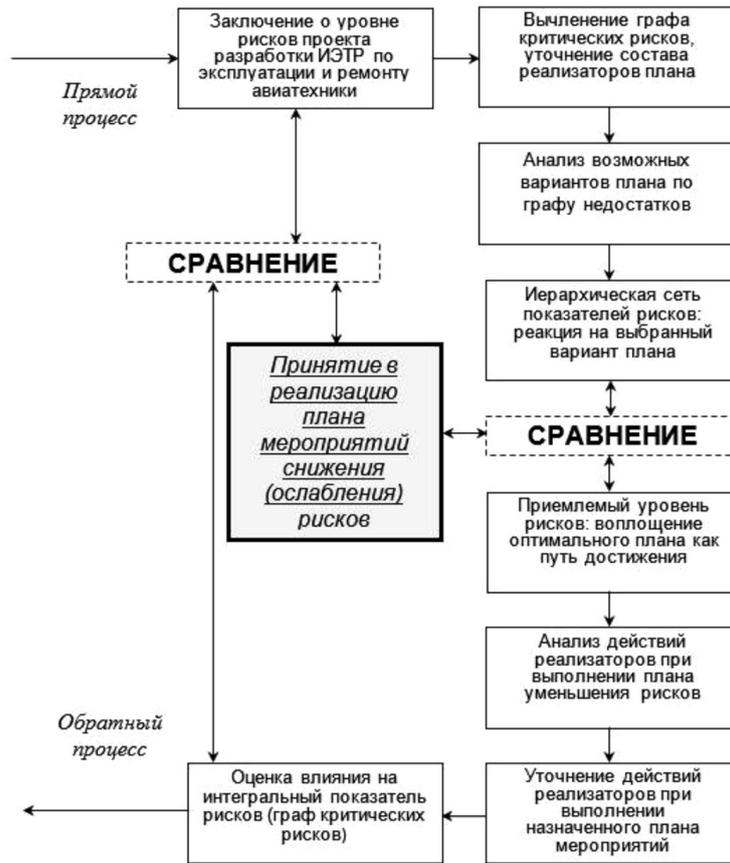
Рис. 2. Логическая структура планирования мероприятий по уменьшению рисков разработки ИЭТР по эксплуатации и ремонту авиатехники
