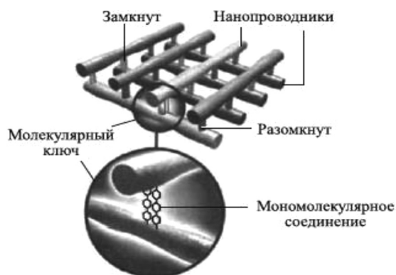
Рис. 2. Кроссбар структура, исследуемая компанией Hewlett-Packard
