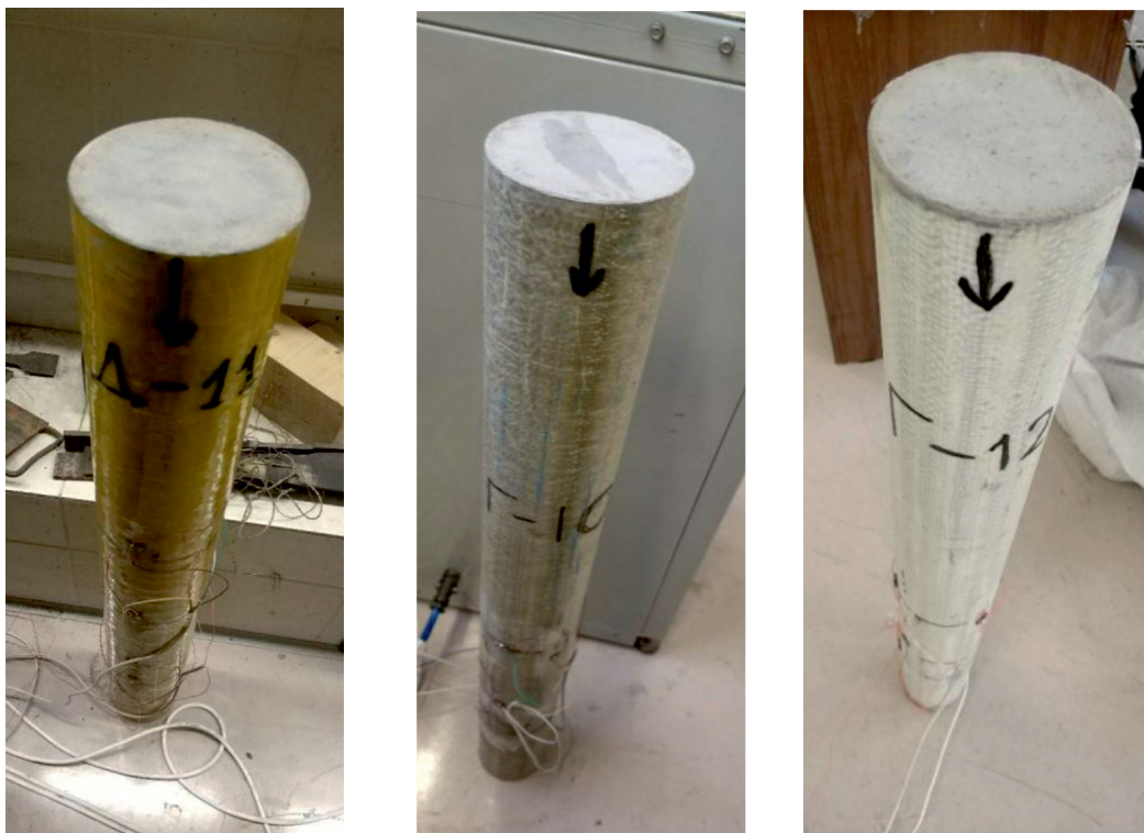
Рис. 1. Образцы для испытания гибридных стеклопластико-трубобетонных стоек с оболочками разных марок стеклопластика (слева направо): КТ-18, СО-40, СА-20
