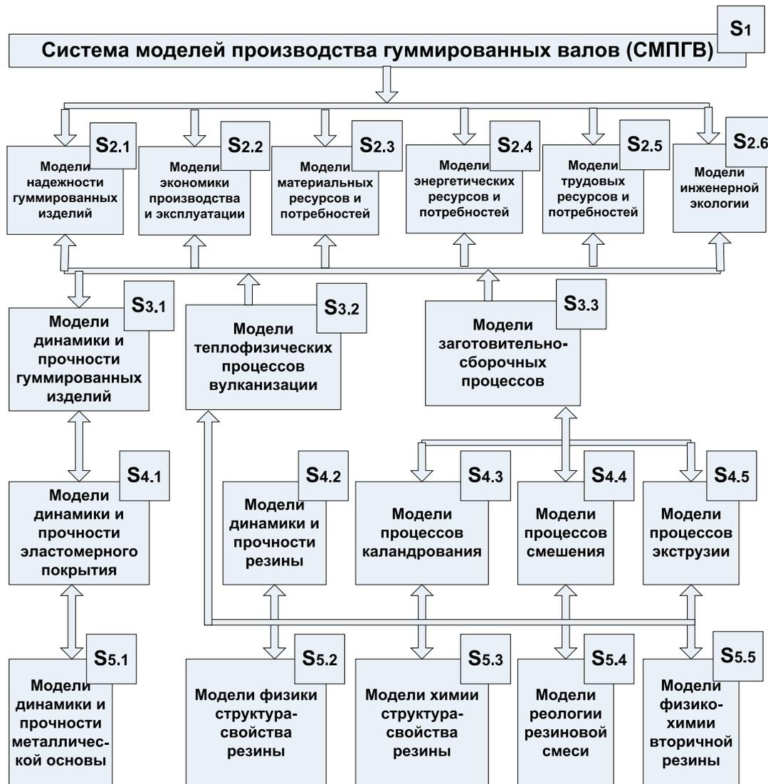
Рис. 1. Система моделей производства гуммированных валов (СМПГВ)
