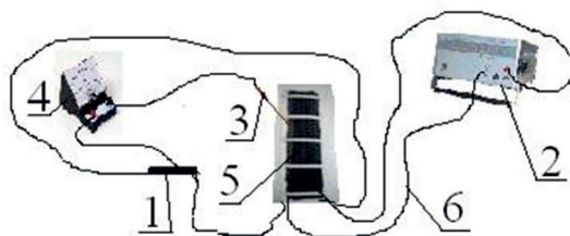
Рис. 1. Исследовательская установка с плоской моделью фильтра: 1 – реохорд – полоска УВС; 2 – блок питания постоянного тока Б5-49, 3 – ручка-цип металлический, 4 – гальванометр, 5 – модель, 6 – медный провод
