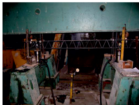
Рис. 4. Общий вид испытания каркаса
