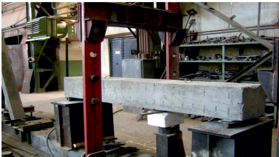
Рис. 1. Полистиролбетонная балка на опорах в Испытательном центре
