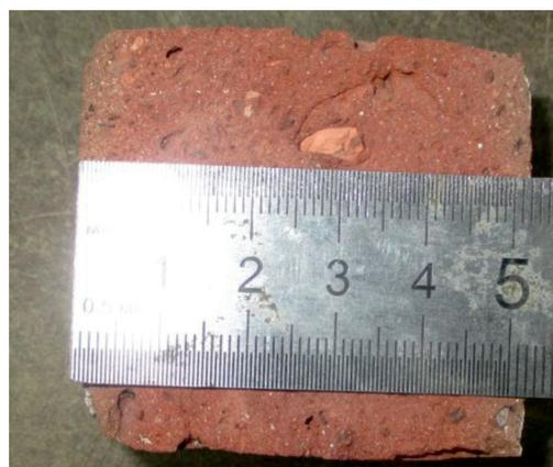
Рис. 3. Образец размером 50x50x50 мм
