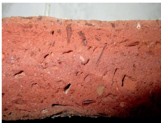
Рис. 2. Внутреннее строение керамической полнотелой плинфы в разрезе
