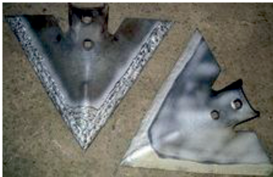
Рис. 2. Лапа культиватора после обработки на установке для плазменного напыления (слева – с нанесением упрочнения по существующему методу; справа – на установке для плазменного напыления)
