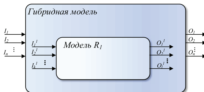
Рис. 5. Пример реализации гибридной модели с функциональным замещением
