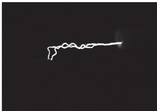
Рис. 4. Фотография разрядов, сделанная с помощью высокоскоростной камеры
