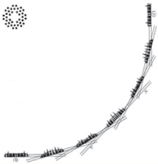
Рис. 1. Компоновка трубок излучателя; суммирование мощностей излучения трубок при перемещении пятна в разных направлениях
