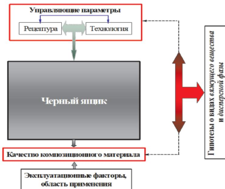
Рис. 1. Схема конструирования КМ с использованием модели «черного ящика»
