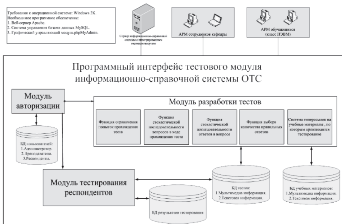
Рис. 2. Структурно-функциональная схема тестового модуля ИСС
