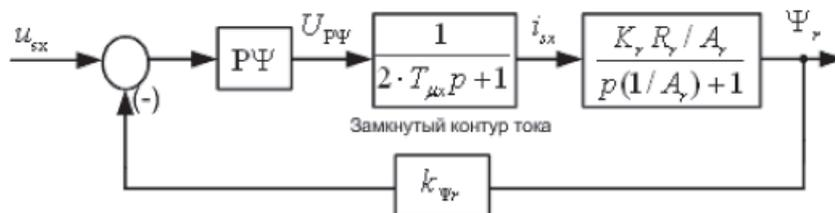
Рис. 5. Структурная схема контура потокосцепления
