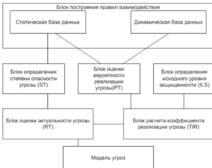
Рис. 1. Функциональная схема процесса автоматизации формирования модели угроз безопасности
