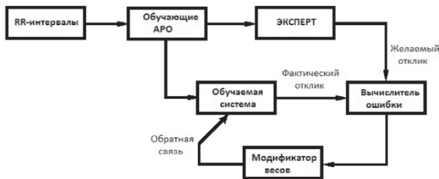
Рис. 3. Структурная схема блока обучения сети (БОС)
