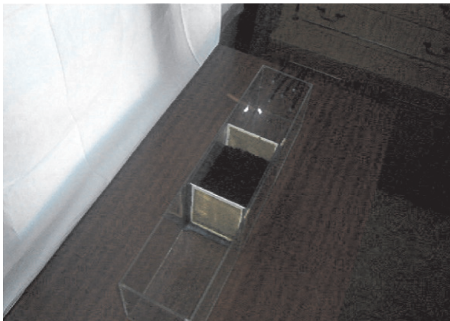
Рис. 4. Экспериментальная установка очистки нефтесодержащих сточных вод с адсорбирующей каскетой
