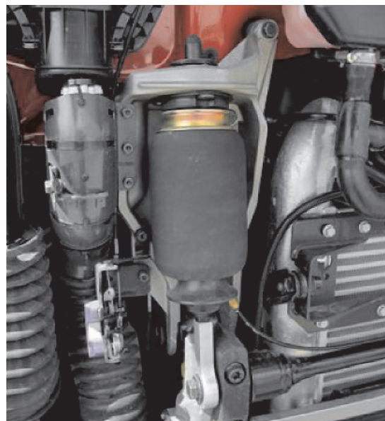
Рис. 2. Четырёхточечная пневматическая подвеска кабины автомобиля SCANIA Griffin
