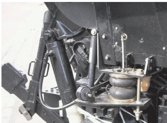
Рис. 6. Двухрежимная (полевой и дорожный) пневматическая подвеска кабины колёсного трактора MT500B TECHSTAR Features
