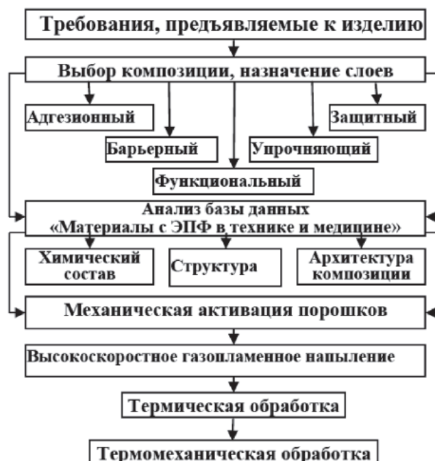
Рис. 1. Технологическая схема формирования многофункциональной поверхностной композиции из материалов с ЭПФ
