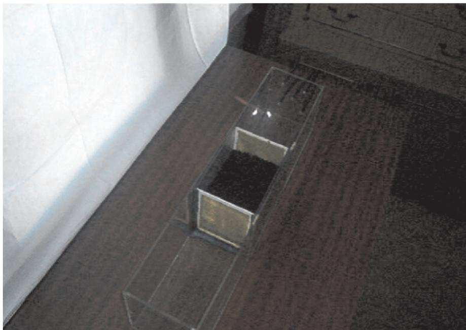
Рис. 4. Экспериментальная установка очистки нефтесодержащих сточных вод с адсорбирующей кассетой
