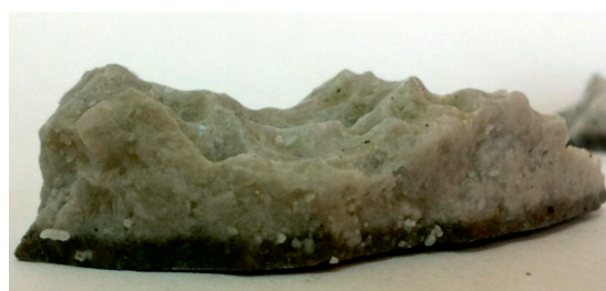
Рис. 5. EDS спектры Li-Na-K эвтектики до и после взаимодействия с золой отходящих газов (А) и фотография закристаллизованного расплава после взаимодействия с золой (Б). Темный слой в донной части образца (Б) соответствует осевшей пыли
