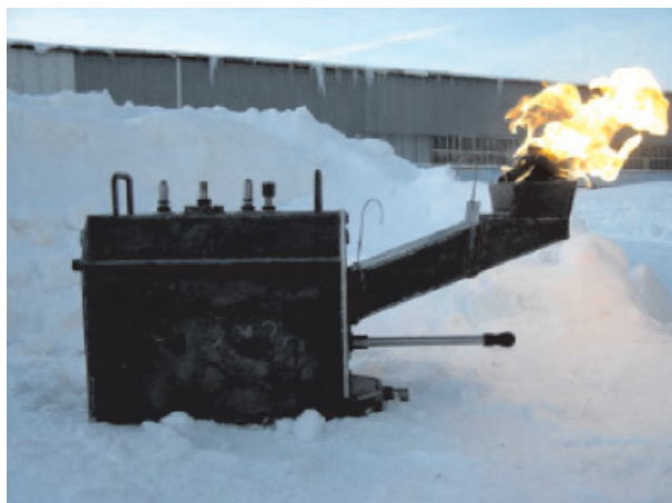
Рис. 6. Испытание на работоспособность парогенератора
