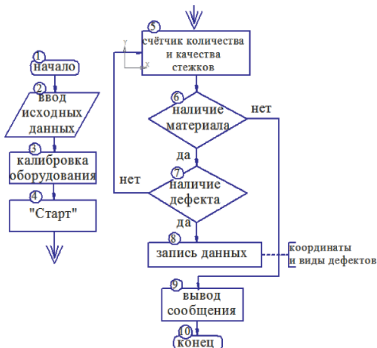
Рис. 5. Блок-схема алгоритма обработки информации о параметрах качества швейной строчки
