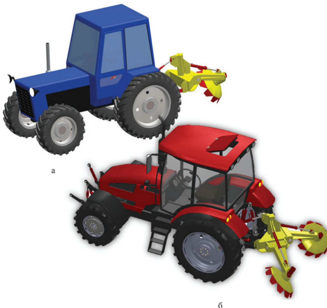
Рис. 5. Общий вид МТА: а – на базе трактора МТЗ-82 (однодисковый рыхлитель); б – на базе трактора МТЗ-1523 (двухдисковый рыхлитель)
