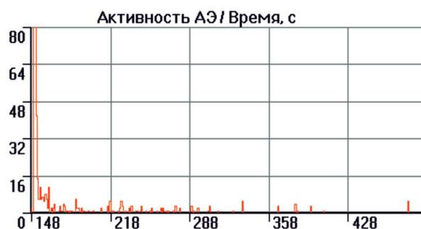
Рис. 4. Изменение активности акустической эмиссии в период токовой нагрузки 1,3 А
