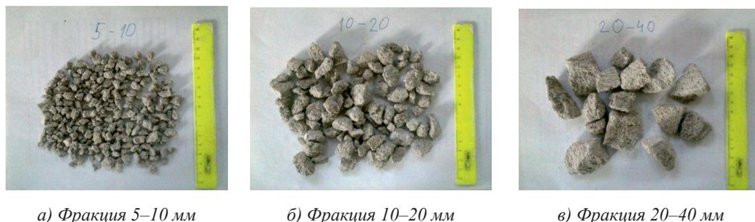
Рис. 1. Фракционированный щебень из отходов автоклавного пенобетона
