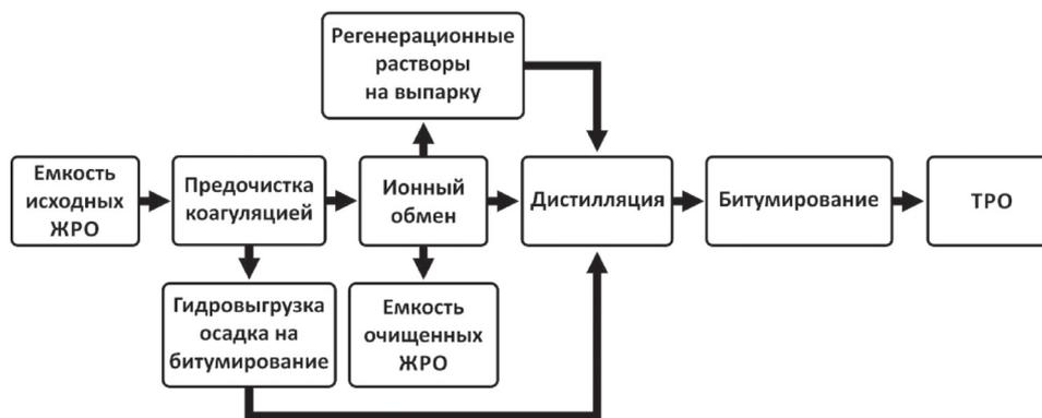
Рис. 1. Технологическая схема переработки ЖРО, содержащих морскую воду, на техническом танкере «Пинега»
