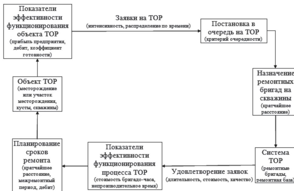
Рис. 1. Процесс организации TOP на скважинах
