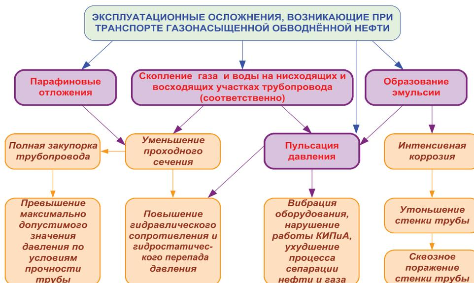
Рис. 2. Эксплуатационные осложнения, возникающие при транспорте гетерогенных сред
