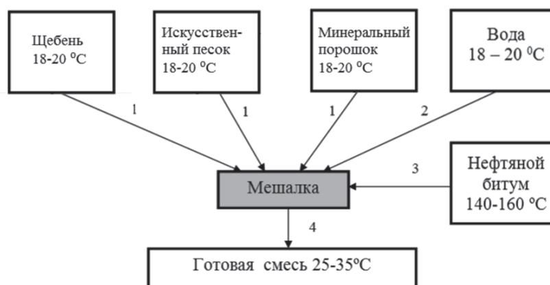
Схема приготовления композиционной холодной щебёночно-мастичной смеси с дисперсным битумом, 1–3 – последовательность операций
