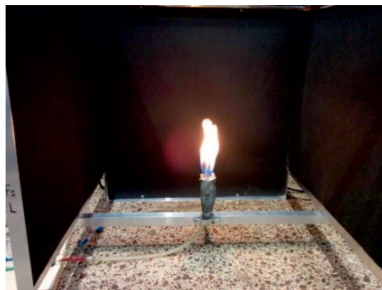
Рис. 1. Фотография работающей эжекционной горелки с закрученными лопатками в модернизированном измерительном комплексе для изучения пульсационного горения
