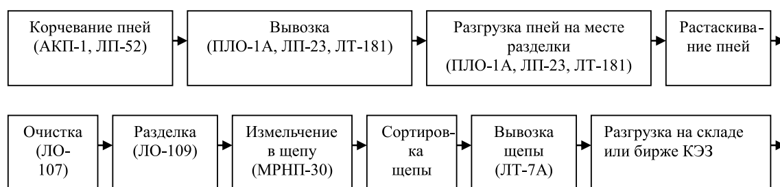
Рис. 1. Схема предлагаемого технологического процесса заготовки спелого и свежего пневого осмола на щепу
