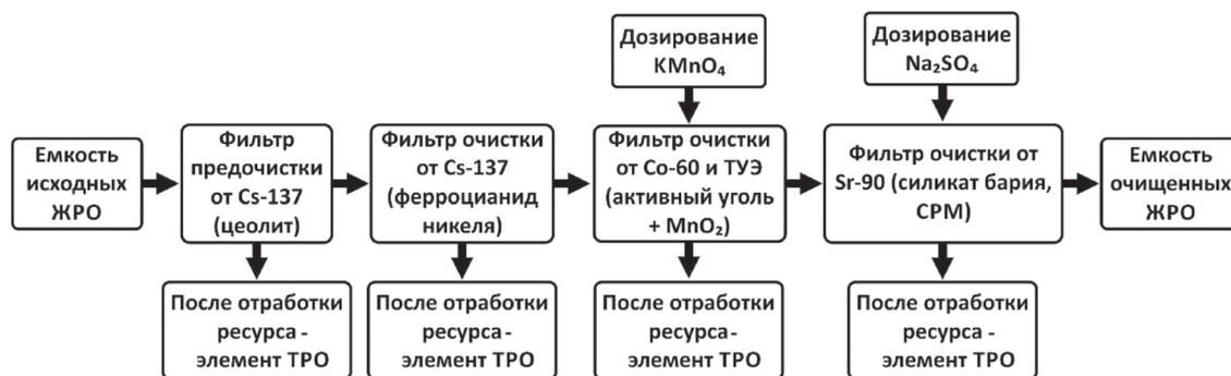
Рис. 3. Опытная установка «Барьер»
