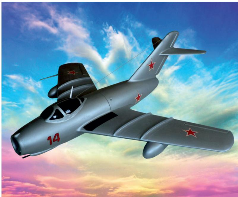
Рис. 9. Летящая модель-копия реактивного самолета-истребителя МиГ-15. Выполнена по описанной технологии с последующим упрочнением стеклотканью  $\delta = 0,005$  мм, 2 слоя
