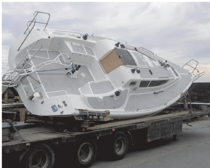
*Рис. 1. Яхта проекта Рикошет-930 установленная под углом на трейлер, при этом обеспечивается соблюдение автогабарита*
