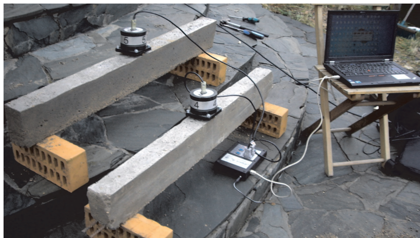
Рис. 1. Динамические испытания бетонных балок
