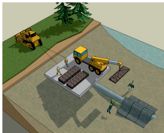
Рис. 3. Балластировка подводного перехода матрацами Рено
