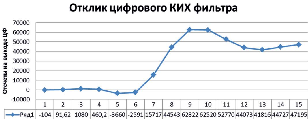
Рис. 3. Отклик позиционного цифрового КИХ фильтра
