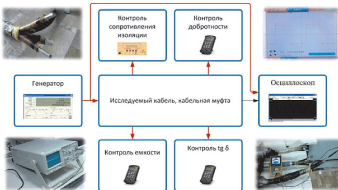
Рис. 3. Структурная схема экспериментальной установки
