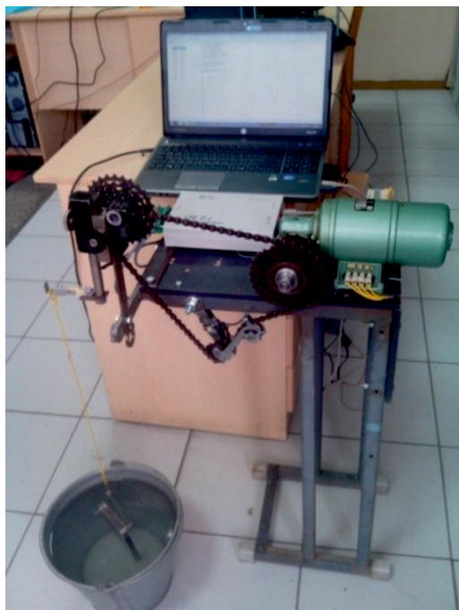
Рис. 1. Стенд для определения коэффициента вязкого трения на малых скоростях
