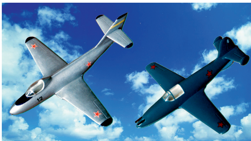
Рис. 7. Летящие модели-копии реактивных самолетов Як-32 и Би-1. Выполнены из пенолиста по описанной технологии
