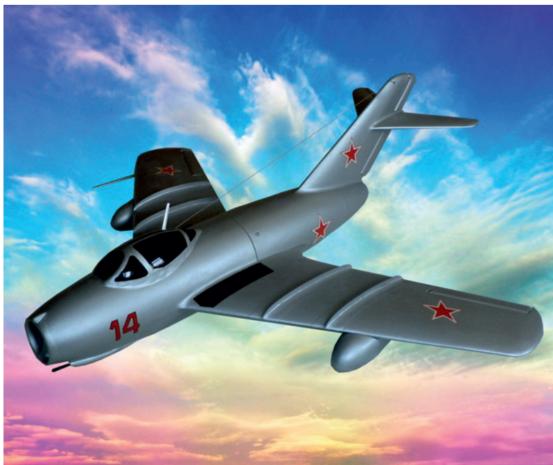
Рис. 9. Летающая модель-копия реактивного самолета-истребителя МиГ-15. Выполнена по описанной технологии с последующим упрочнением стеклотканью \delta = 0,005 мм, 2 слоя
