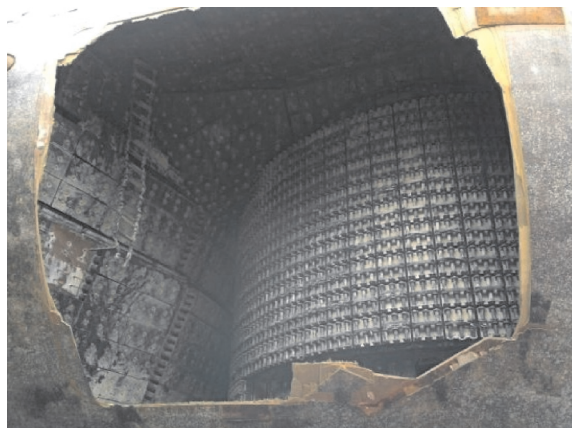
Рис. 3. Поврежденный обтекатель ПЛ пр. 971
