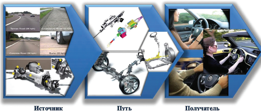
Рис. 3. Анализ структурной вибрации автомобиля с точки зрения «источник – путь – получатель»
