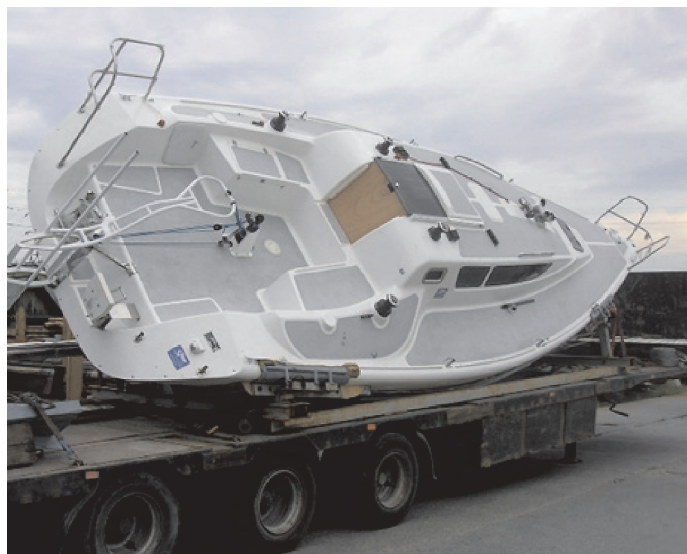
Рис. 1. Яхта проекта Рикшет-930 установленная под углом на трейлер, при этом обеспечивается соблюдение автогабарита
