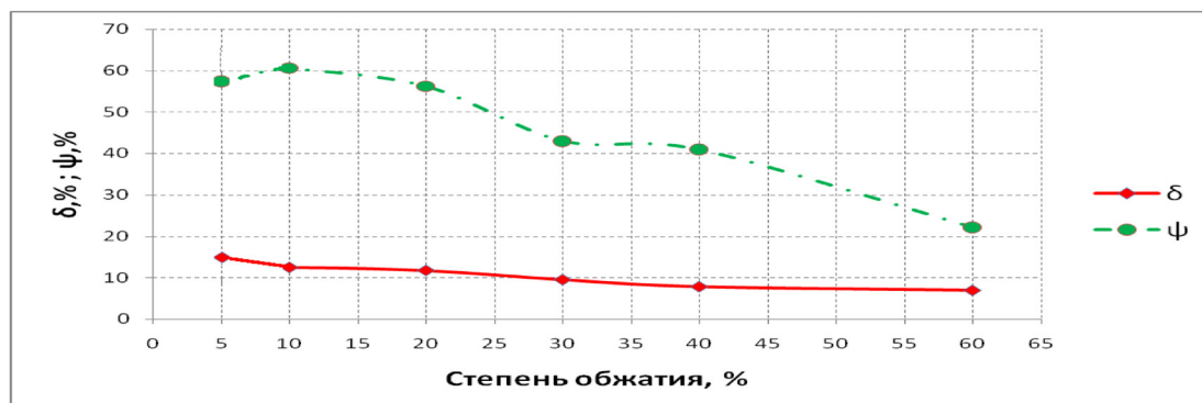
Рис. 4. Зависимость \delta и \psi от степени обжатия при волочении для температуры 400 °С
