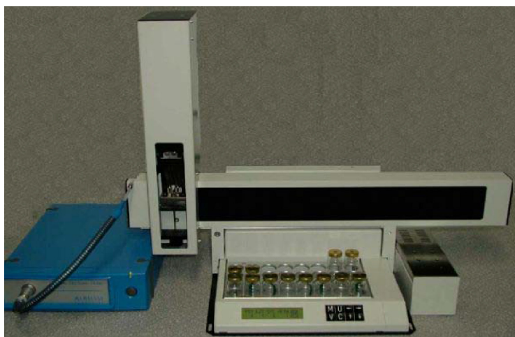
Рис. 4. Внешний вид электронного носа PEN3
